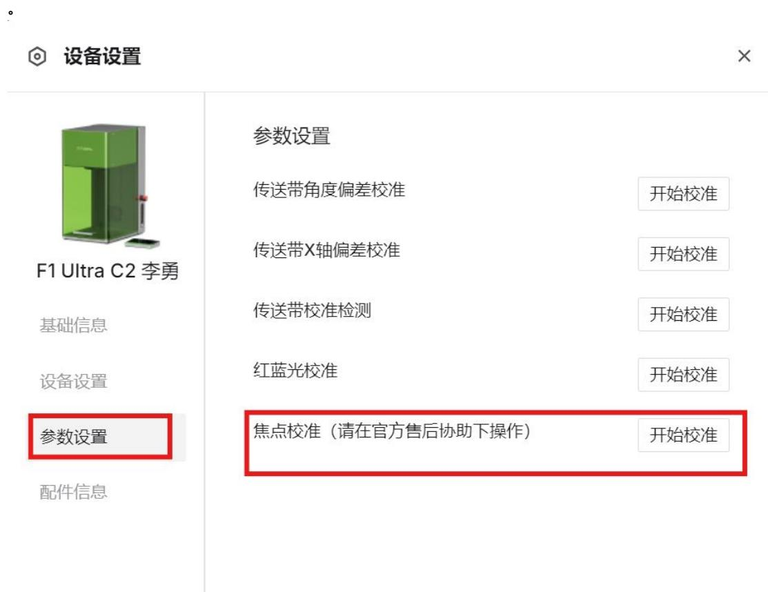
5. **准备目标物:** 将已知厚度（至少 1 毫米厚）的铜币或铜板放置于工作台中。在对焦校准字段中输入铜币或铜板的厚度，然后点击“开始”设置自动对焦。
